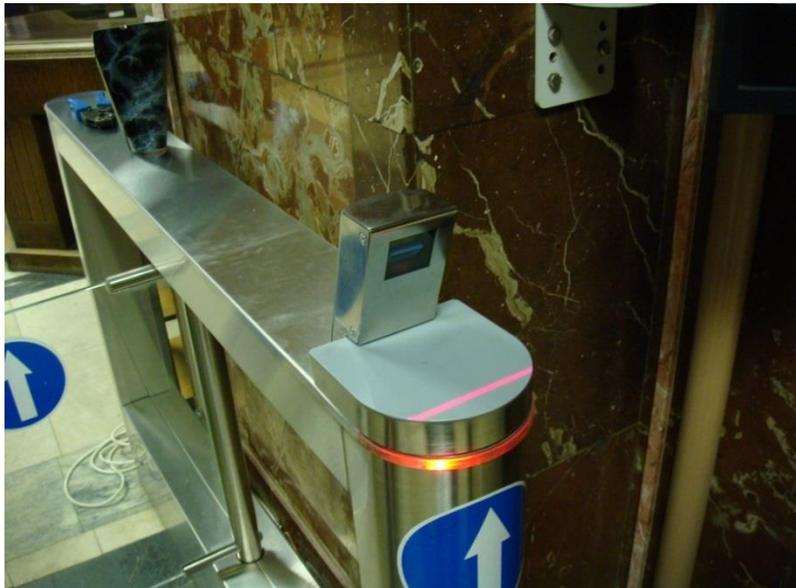
Специально для данного проекта инженерами ООО «РСТ-Инвент» было разработано и произведено оборудование для модернизации турникетов, оснащенное как считывателем штрих-кодов, так и RFID-модулями. В случае необходимости, предусмотрена деинсталляция сканера штрих-кодов без ущерба для внешнего вида турникета и вмешательства в конструкцию.
